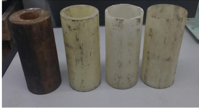
**Figura 19:** Inserções de parafina, para simulação dos bloqueios, por ordem: 75%, 50%, 25% e 10% de obstrução de área
