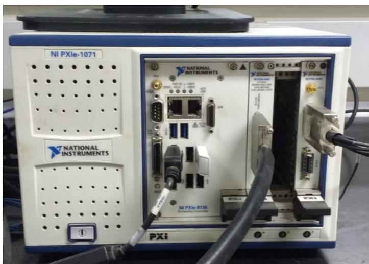
**Figura 23:** Sistema de alta taxa de aquisição de dados NI PXIe-1071, National Instruments
